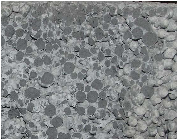
Obr. 4: Mezerovitý beton s umělým kamenivem RUGEN RU kulovité formy
