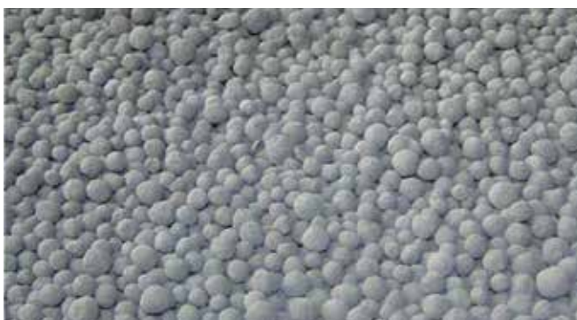
Obr. 2: Umělé kamenivo RUGEN RU nepravidelné formy.
