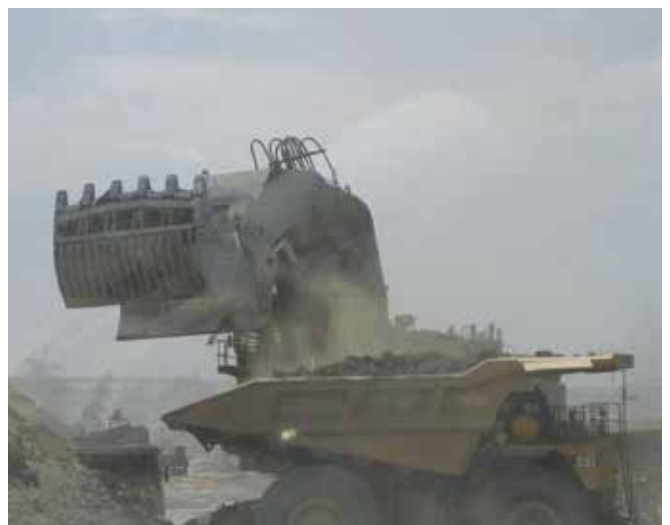
Rys. 9. Koparka łopatowa 11,5 m 3 rozładująca ziemię do wywrotki.
