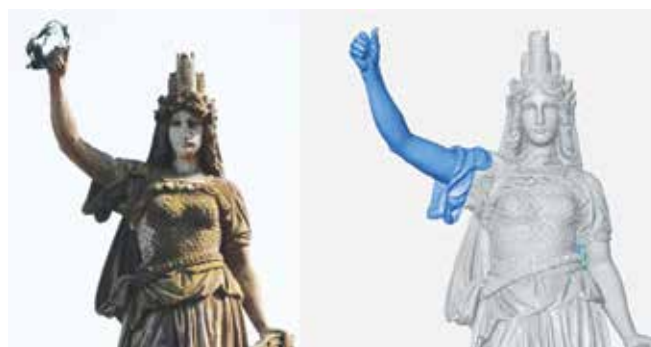
Obr. 7: Skenování sochy Austrie 3D skenerem ATOS (foto: MCAE Kuřim).
