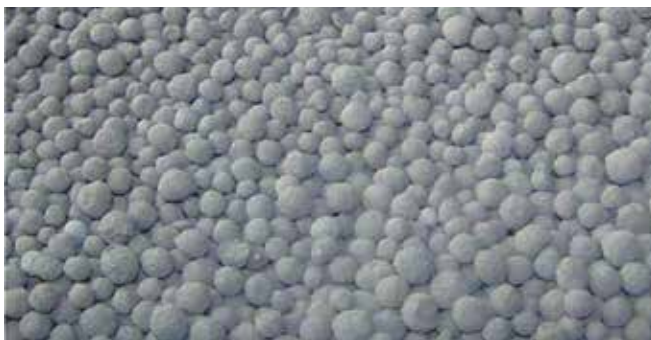
Obr. 1: Umělé kamenivo RUGEN RU kulovité formy.
