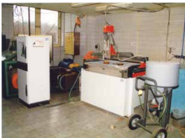
Obr. 1: Sestava vodního paprsku „pod střechou“ pro přesné řezání (dělení) materiálů.
