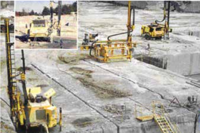
Rys. 2. Urządzenie waterjet „w terenie” do wydobycia bloków granitowych z masywu (Georgia, USA).
