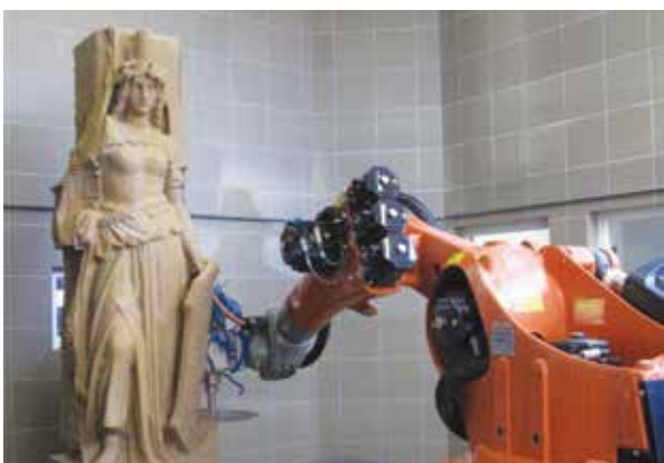
Obr. 9: Obrábění Austrie robotem.
