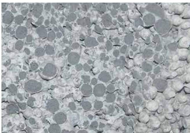
Obr. 4: Mezerovitý beton s umělým kamenivem RUGEN RU kulovité formy.
