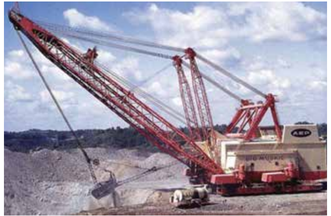
Rys. 7. Koparka zgarniakowa do usuwania nadkładu model B-E 4 250 W, zgarniak o obj. 168 m 3 .
