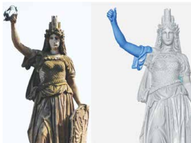
Rys. 7. Skanowanie posągu Austrii przy pomocy skanera 3D ATOS (fot. MCAE Kuřim).
