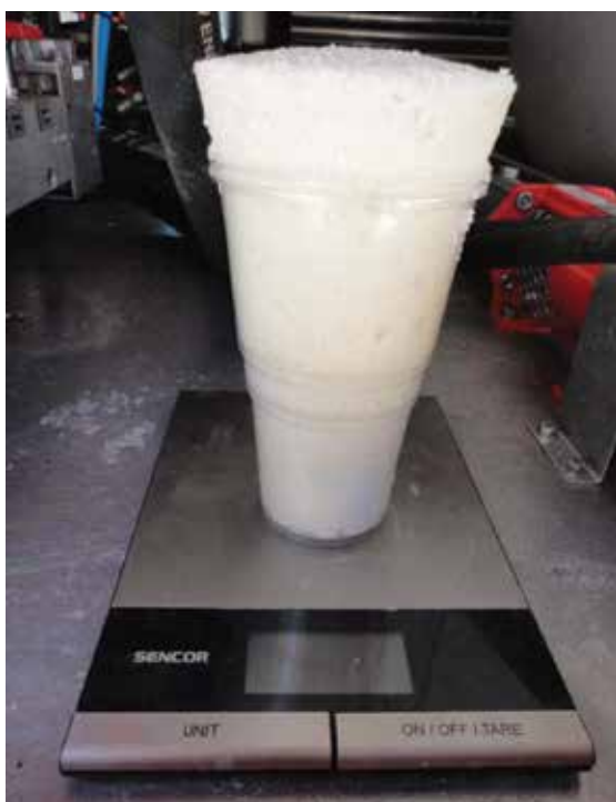
Rys. 2. Test gęstości materiału wybuchowego Hydromite 70.
