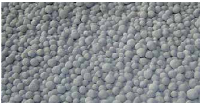
Rys. 2. Sztuczne kruszywo RUGEN RU o nieregularnym kształcie.
