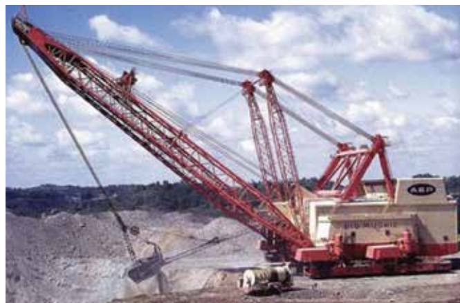
Obr. 7: Dragline pro těžbu skryvky na lomu model B-E 4 250 W, koreček 168 m 3 .
