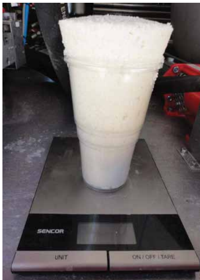
Obr. 2: Test hustoty trhavy Hydromite 70.
