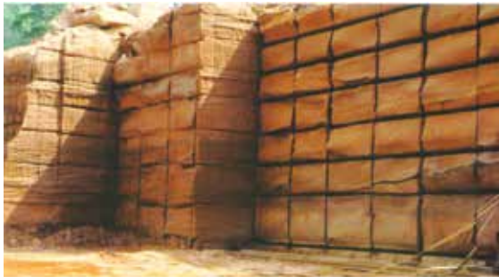
Rys. 3. Wydobywanie bloków piaskowca metodą odkrywkową i tunelową (Francja).
