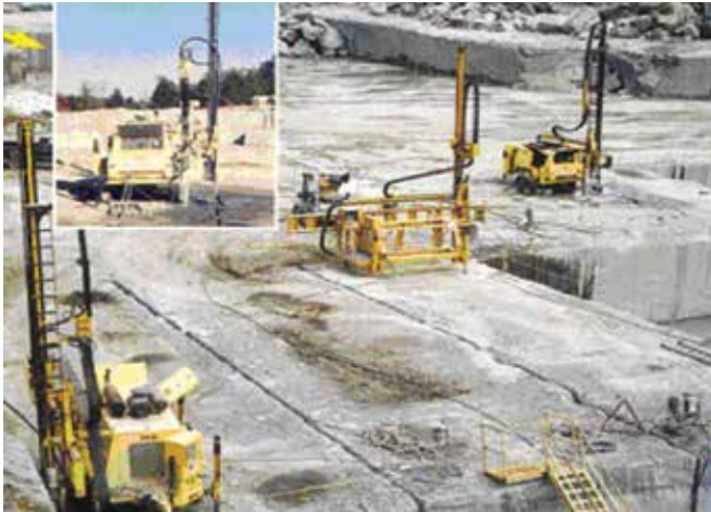
Obr. 2: Sestava vodního paprsku „v poli“ pro těžbu bloků žuly z masívu (Georgia, USA).
