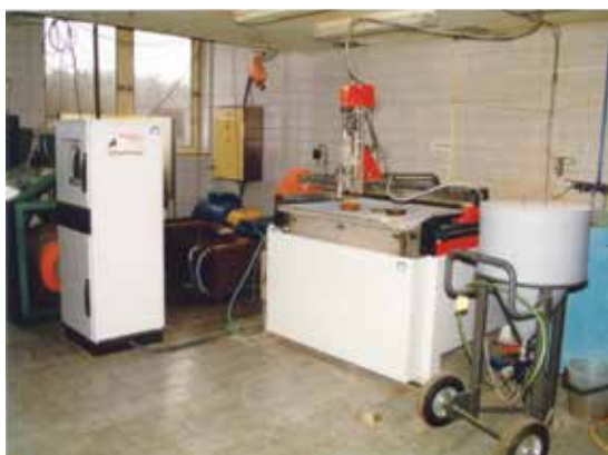
Rys. 1. Urządzenie waterjet „pod dachem” do precyzyjnego cięcia (przecinania) materiałów.
