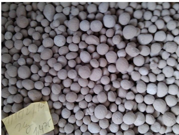
Obrazek 1 – umělé plnivo vyrobené za studena s vysokým podílem fluidního popílku z el. Tisová
