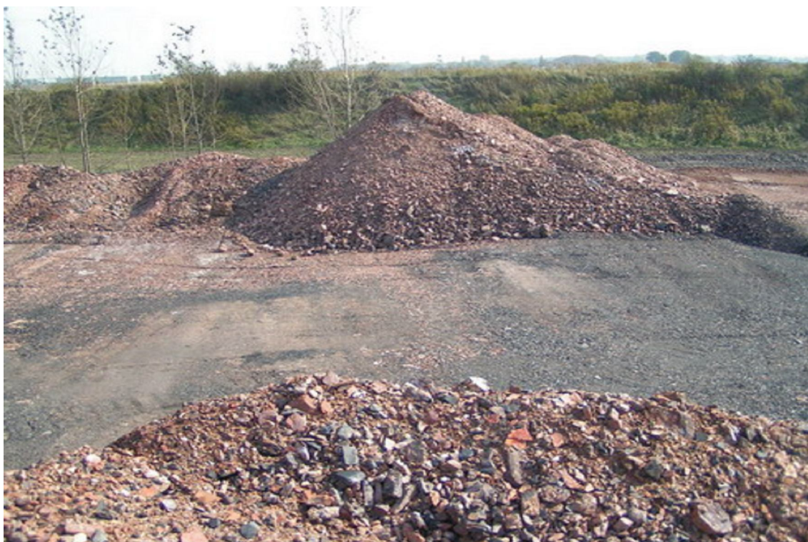
Rys. 7. Pryzmy tworzone dla wychłodzenia materiału skalnego.
